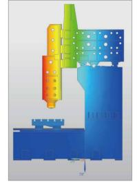
机床结构经有限元分析,已达最佳刚性结构
