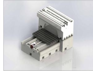
工作台工作行程内完全位于横梁之外, 可使用各种超长工装
