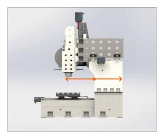
横梁厚度大, 主轴中心到立柱前支撑面距离与立柱厚度比例1:1, 刚性更好
