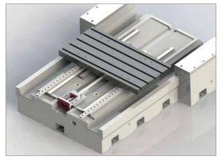
床身两侧为通槽设计,方便前排、后排、螺旋排屑器的配置切换
