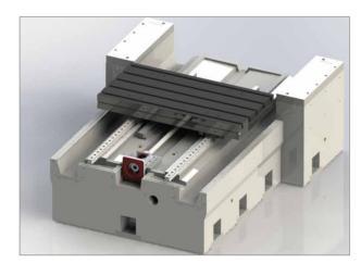
Y轴电机座前置,减少丝杠热伸长带来的零点漂移的影响
