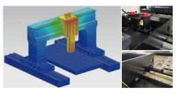
■ X轴采用左右各2个伺服电机同步驱动,采用双减速机齿轮一齿条传动结构,通过双电机电气控制自动消除双向运动间隙,提高定位精度。
