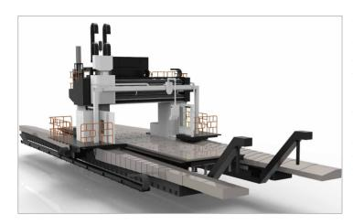
该系列机型采用固定式工作台,由左右拖板、左右立柱和横梁组成刚性龙门框架结构,龙门框架沿左、右床身导轨水平纵向移动(X轴),横梁上配备滑座及垂直主轴箱(滑枕式镗铣头),滑座沿横梁导轨左右运动(Y轴),垂直主轴箱沿滑座的竖直导轨上下运动(Z轴)。
