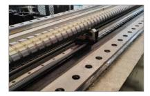
Y、Z、W轴采用滚珠丝杠,通过交流伺服 电机、高精度行星齿轮减速器减速传动。
