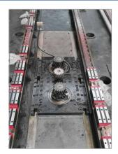
X轴采用双减速机齿轮一齿条传动结构,通过双电机电气控制 自动消除双向运动间隙,提高定位精度和重复定位精度。
