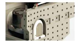
机床采用U型床身结构和尾座单元,保证了运动部件高速运动或大负荷切削时机床的稳定性。
