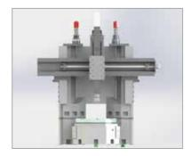
4) 转台使用大跨距高精密交叉滚子轴承,使得转台可以进行稳定运转的同时又承载各方向载荷,保证重切加工。
